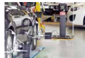
四輪アライメントテスターと呼ばれる機器で、ホイールアライメントの調整を行う
