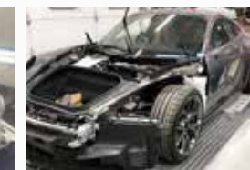
施工のため、バンパが取り外されたボルシェGT3
