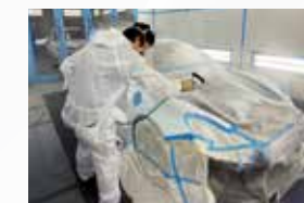
塗るタイプのペイントプロテクションフィルム施工の様子
