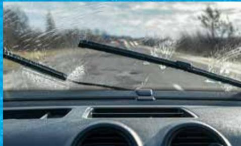
不足した状態でワイパーを動かすと、汚れが落ちないことに加え、例えばフロントガラスに砂利などの大きな粒子が付いていると、ガラス面に傷が入ってしまう可能性もある。その意味で、ウォッシャー液は視界の確保だけではなく、ガラスの保護にも一役買っているのだ。
