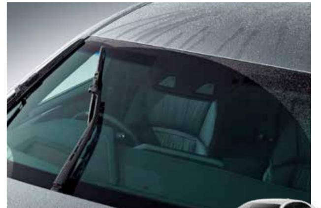
ダイレクトスプレー機能付雨滴感知式オートワイパーウォッシャーノズルをブレードに内蔵。ウォッシャー液の噴射エリアをブレード周辺に絞ることを可能とし、より良好な視界確保を実現している ※画像出典:LEXUS LSホームページより
