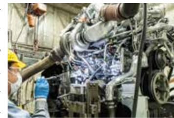
両者の大きな違いは「リユースパーツ」が基本的には取り外した部品の分解を行わないのに対し「リビルトパーツ」は、構成部品の交換、再組み立てを行う点にある。
