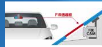
可視光を透過させるフロントガラスの一部を特殊加工。その部分をFIR光を透過させる特殊素材に置き換えることで、FIRカメラを車室内の可視カメラの横に設置することが可能に
